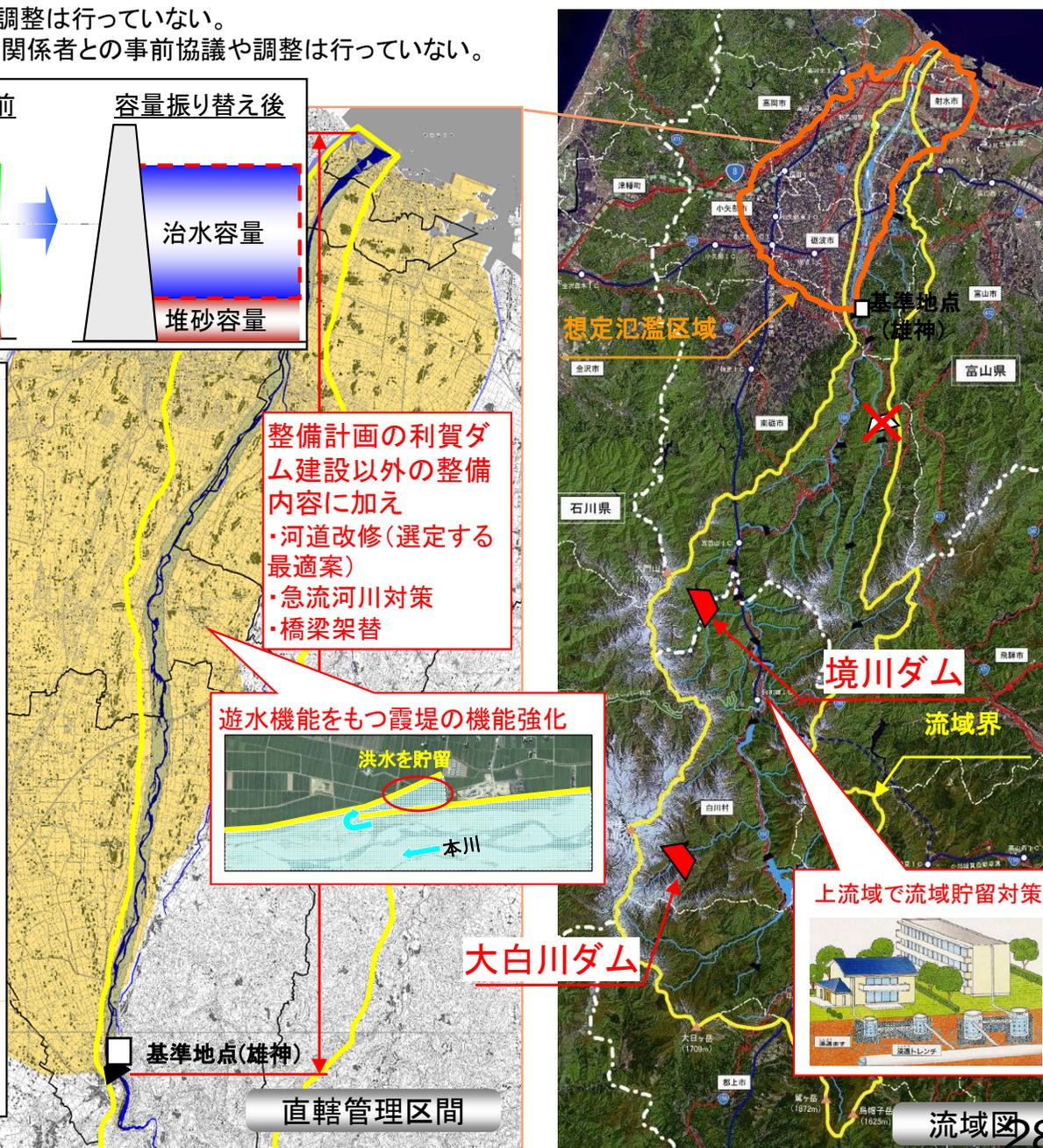
河川整備計画の利賀ダム建設以外の整備内容に加え、境川ダム嵩上げと大白川ダムの治水容量概要: の振り替えにより治水容量を確保し洪水調節を行うとともに、不足する分を流域貯留対策、現存する霞堤の遊水機能向上と河道改修で対応し、河川整備計画と同程度の治水安全性を確保する。
